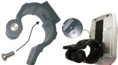
2. Spreid de onderkant van de consoleklem uit elkaar en klem hem dan weer in elkaar via het midden van het bovenste deel van de stuurstang.
