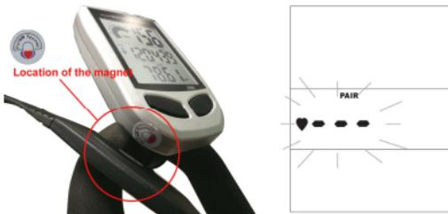
Si la valeur de fréquence cardiaque est affichée sur l'écran, la synchronisation a fonctionné. Au contraire, si le moniteur affiche '**Err**', la synchronisation a échoué. Appuyez alors sur SET et recommencez la synchronisation. Sinon, l'écran sort de la synchronisation automatiquement après 10 secondes
