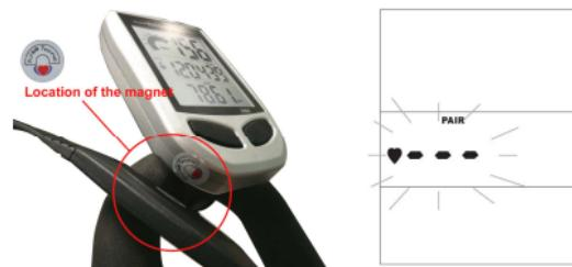
Wanneer de hartslagwaarde wordt weergegeven op het LCD scherm is de koppelingsfase met succes uitgevoerd.
