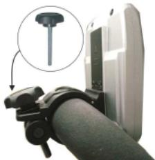
3. Gire la barra del tornillo hacia abajo, apriete ligeramente el tornillo y ajuste la consola para una visibilidad óptima. Una vez ajustada la consola, siga apretando el tornillo hasta que esté correctamente insertado en la barandilla.
