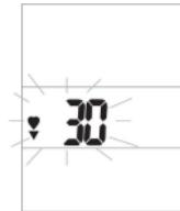
Appuyez sur la touche SET pour augmenter la limite de fréquence cardiaque maximum. Après le réglage, appuyez sur MODE pour ajuster la limite de fréquence cardiaque minimum.
