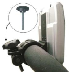
3. Introduire la vis de fixation, tête vers le haut, puis serrer sans forcera avant de régler le compteur pour avoir la meilleure visibilité possible. Une fois le compteur correctement installé, serrer la vis pour assurer une bonne fixation au guidon.
