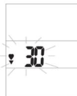
Presione 'SET' para aumentar el límite máximo del ritmo cardiaco. Luego de ajustarlo, presione MODE para ajustar el límite.
